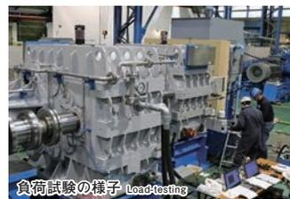
負荷試験の様子 Load testing
